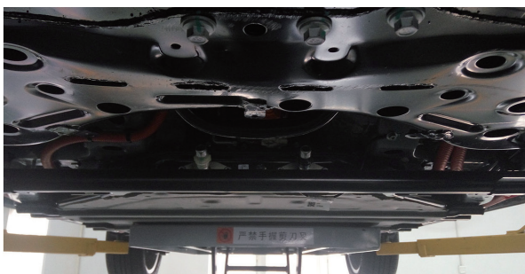
▲ 图 1-1-9 纯电动汽车底盘上的电池
